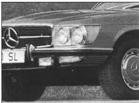
Avant 08/1974 : petit pare chocs avec butoirs, clignotants de la même forme que les ouvertures à lamelles.
