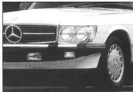
Après 09/1974 : gros pare chocs avec butoirs, clignotants rectangulaires
